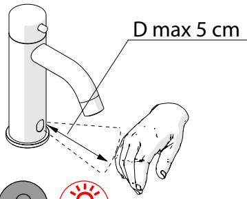
3. Posizionare immediatamente una mano davanti al sensore (max 5 cm di distanza) mentre il led rosso lampeggia (se si spegne è necessario togliere nuovamente l'alimentazione e ripetere l'operazione);
