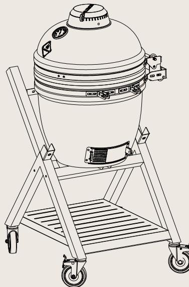
Plasser Kamado-kroppen sentralt på vognens bærebjelker (2), med innløpsventilen vendt mot høyre. På grunn av vekten på denne grillen anbefaler vi på det sterkeste at to personer utfører denne oppgaven!
