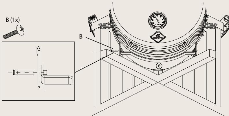
Het wordt aangeraden en het is veilig om de schroef er niet helemaal in te draaien, mits de verbinding stevig is.
