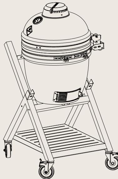
Platzieren Sie das Kamado-Gehäuse mittig auf den Stützbalken des ② Rollwagens, wobei die Lufteinlassöffnung nach rechts ausgerichtet ist. Aufgrund des Gewichts dieses Grills empfehlen wir dringend, dass zwei Personen diese Aufgabe durchführen!
