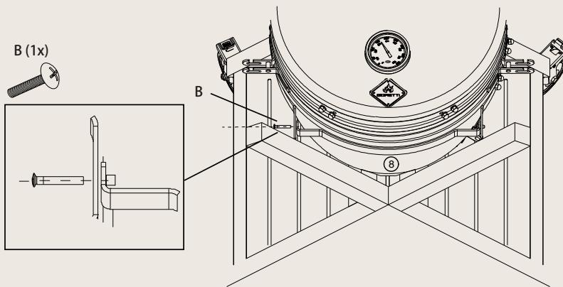
Il est conseillé de ne pas serrer la vis à fond, cela est sans danger à condition que la prise soit assurée.
