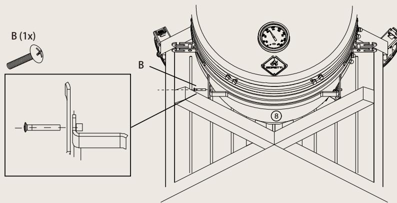
Es wird empfohlen, die Schraube nicht bis zum Ende festzuziehen, solange die Verbindung gesichert ist.
