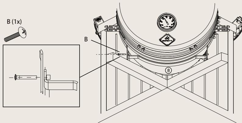
Se till att skruvförbandet har säkrats ordentligt, men spänn inte skruv och mutter helt förrän mot slutet av monteringen.
