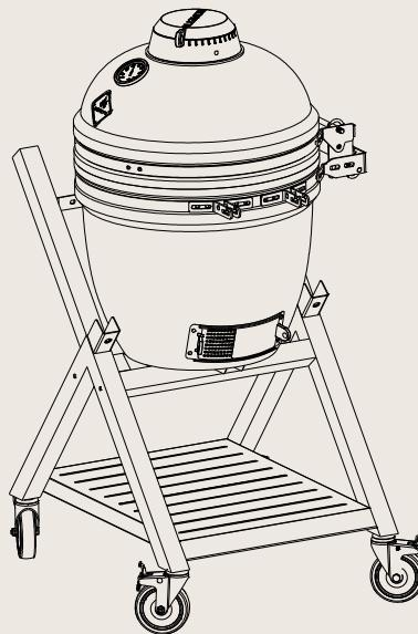
Placer le corps du Kamado centré sur les poutres de support du chariot ②, en orientant l'entrée d'air vers la droite. En raison du poids de ce grill, nous recommandons vivement que cette tâche soit effectuée par deux personnes !
