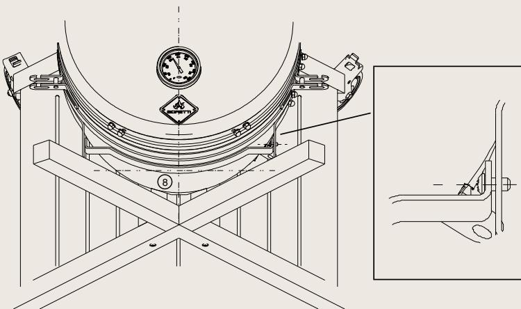
Während Sie Schritt 11 und Schritt 12 ausführen, zentrieren Sie bitte den vorderen Verschluss (8) und passen Sie ihn von Zeit zu Zeit so weit wie möglich an das Kamado-Gehäuse an.
